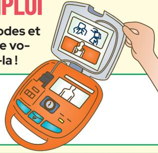
**1 Appuyer sur le bouton on/off** pour allumer l'appareil. La voix de guidage démarre ses instructions.
